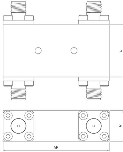
90° 3dB电桥外形尺寸示意图
