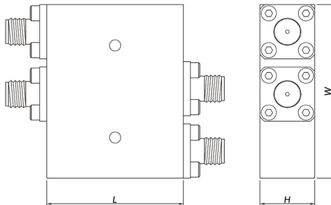
180° 3dB电桥外形尺寸示意图
