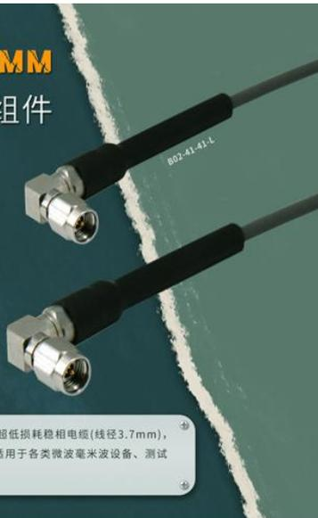
产品采用90°一体式弯针结构2.92MM直角连接器，配接B02超低损耗稳相电缆(线径3.7mm)，衰减、驻波比性能指标优异，结构可靠，稳幅稳相性能好，适用于各类微波毫米波设备、测试仪器、模块之间的连接及相控阵雷达与5G测试应用。
