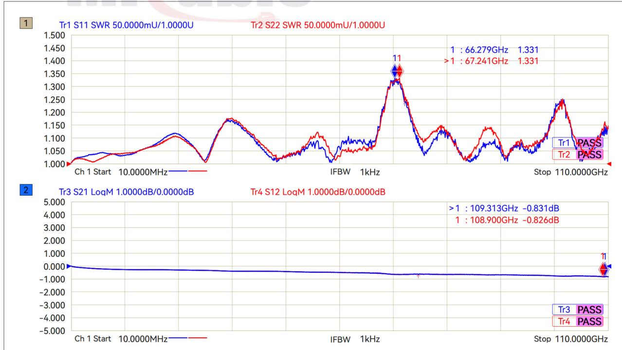
注：测试曲线数据为0.8mm公、0.8mm母配对后测试所得，插损为一对转接器测试数据。
