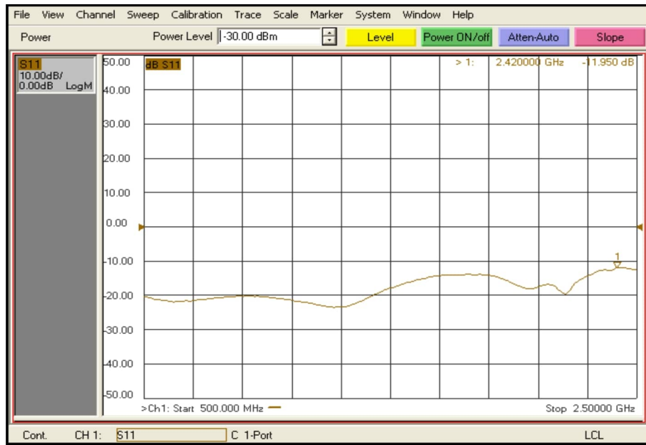
输入回波损耗 S11 (Pin=-30dBm, 连续波, 负载驻波 \leq 1.2 , 25°C), 参考曲线
